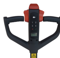
LCD-Display - Batterie-Entladeanzeiger, Betriebsstundenzähler, Fehlermeldungen. Schlüsselloch durch integriertes Pincode-Panel.
