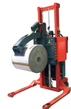
La pinza para bobinas del Rotator permite transportar, elevar y voltear bobinas pesadas 90° a cada lado.
