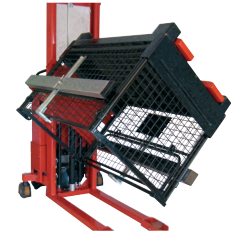
El Rotator puede girar una caja 180° para vaciarla por completo cuando está equipado con soportes para cajas con pinzas.
