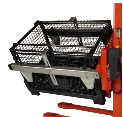
Rotator con soportes ajustables para cajas con pinzas y dos juegos de placas de soporte laterales.
