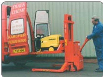
Aquí se usa la plataforma para transportar una limpiadora de alta presión.
